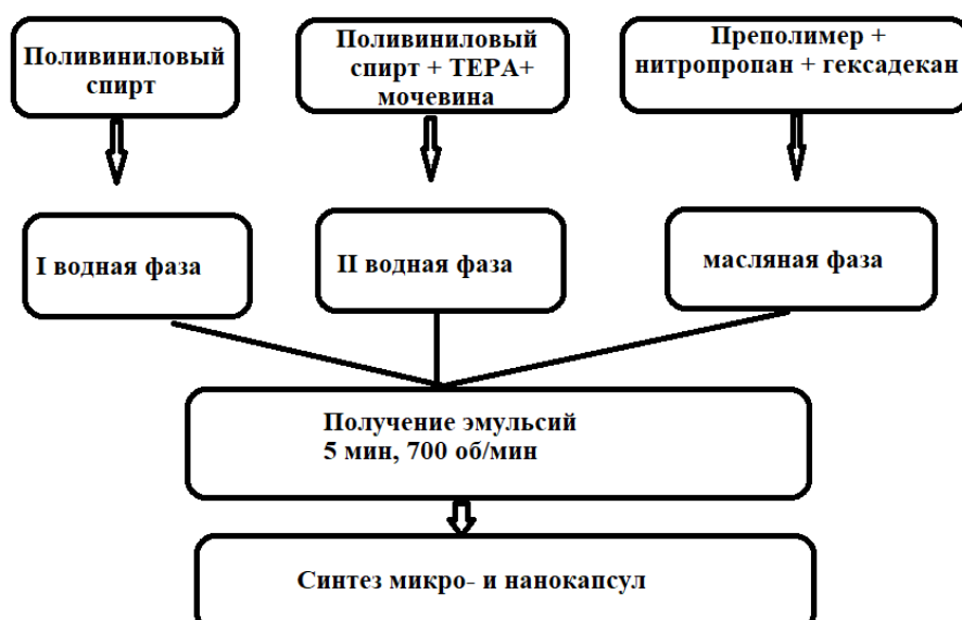
Рисунок 5 – Схема синтеза микрокапсул с оболочкой из полимочевины и ядром из DCOIT
